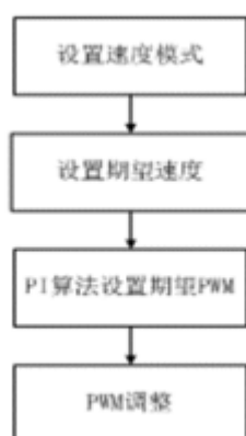
图 4-9 速度控制流程图
