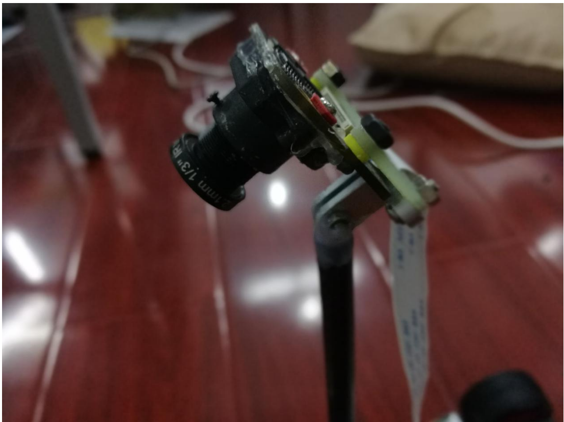
图 2.2 数字摄像头安装示意图
