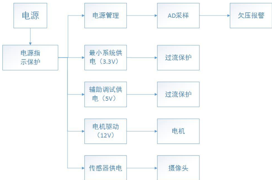
图 3-1 电源部分系统框图
