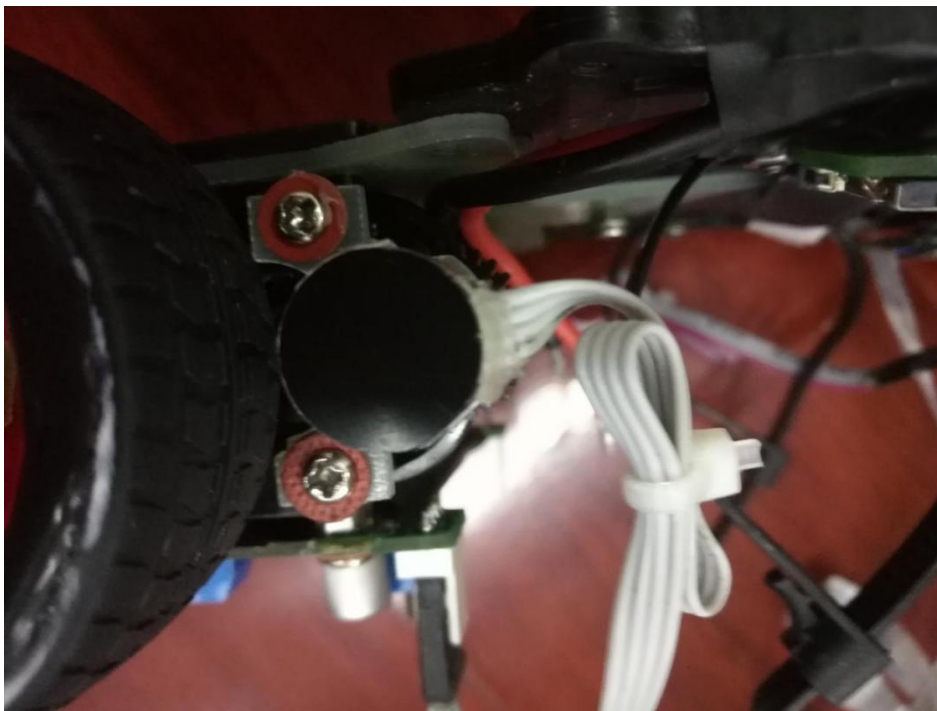
图 2.6 编码器固定示意图
