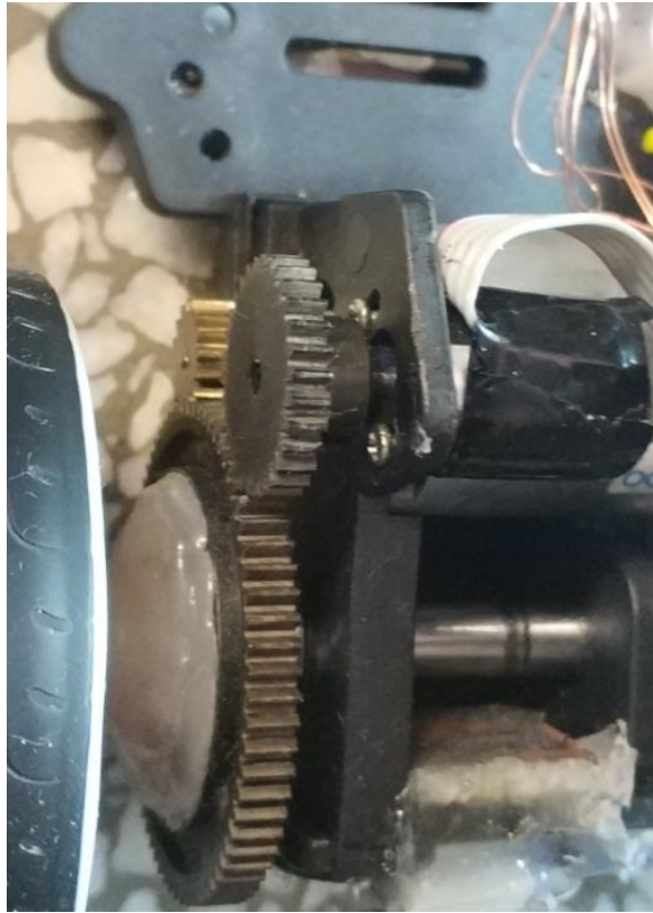
图 2.2 编码器安装图
